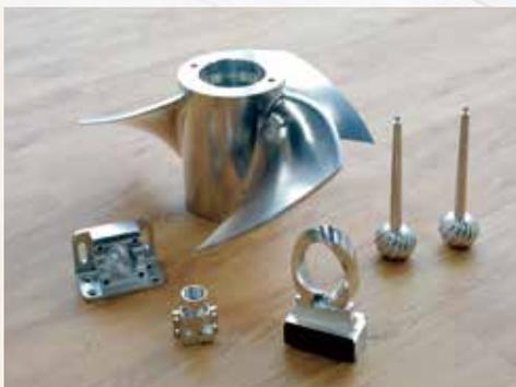
HILLTOP工場で製造されたアルミ部品。これらの細かい加工が全て、プログラムと無人稼働の機械でできる。
