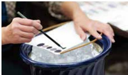
(右) 意匠通りの色をつくるのに不可欠なのが「色合せ」の作業。その日の温度や湿度によって微妙に変化する染料で色を合わせるのも職人技だ。(左) 京友禅では彩色の工程を「色挿し」と呼ぶ。下から温めると乾燥が早まり、にじみを防ぐことができる。また、染料が表面に定着し発色も良くなる。
